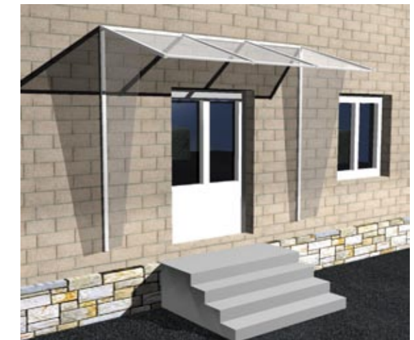
Рисунок 45. Г-образная конструкция козырька.
