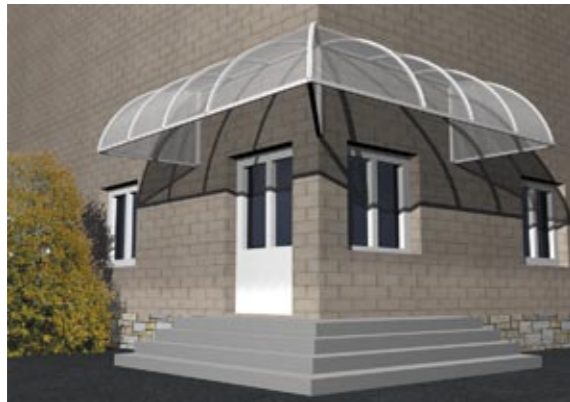
Рисунок 51. Угловая конструкция козырька.
