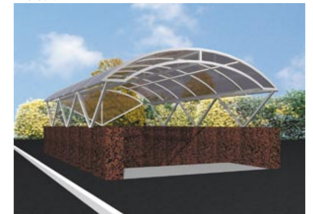
Рисунок 99. Типичная арочная конструкция укрывающего ограждения подземного перехода.
